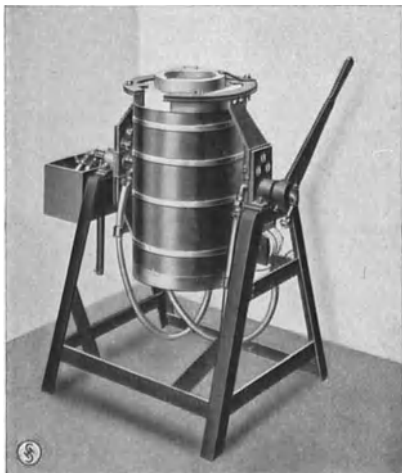
Abb. 70. Hochfrequenzofen, System Siemens & Halske, für Laboratoriumszwecke.
