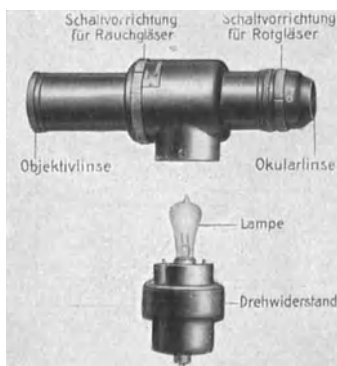
Abb. 61. Siemens-Glühfaden-Pyrometer. Das Fernrohr hat eingebaute Rotgläser und Rauchgläser zum Ändern der Meßbereiche.
