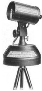
Abb. 53. Das Ultrameter von Dr. R. Hase zur Strahlungsmessung bei Temperaturen von 100 bis 500° C.
