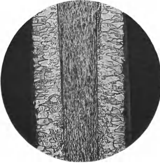
Abb. 20. Längsschliff eines feinkristallinen Anwachskristalles.
