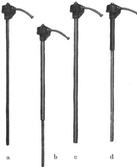
Abb. 36. Verschiedene Armaturen für Thermoelemente. a mit emailliertem Eisenschutzhrohr, b mit Nickelchromschutzhrohr (Verlängerung aus Stahl), c mit gegossenem Metallschutzhrohr, d mit keramischem Schutzhrohr und Einbaustützen aus Stahl.
