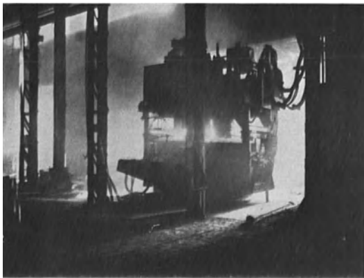
Abb. 60. 4 t-Drehstromlichtbogenofen, System AEG.
