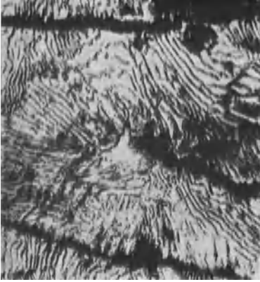
Abb. 65. Gefüge eines im Elektroofen hergestellten Perlitgusses.
