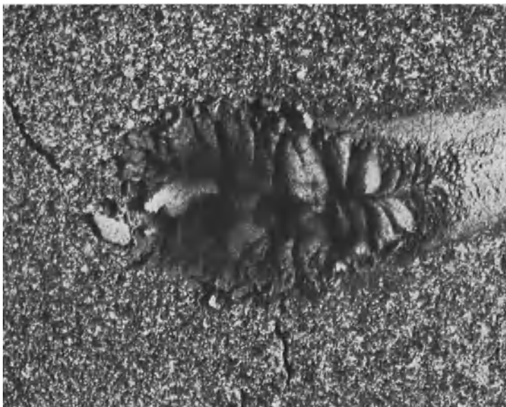
Abb. 26. Bohrloch mit geflossenem Graphit.
