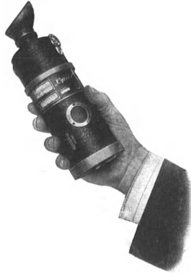
Abb. 66. „Optix“-Temperaturmesser von Dr. R. Hase mit Vergleichslampe und drehbarem Graukeilring.
