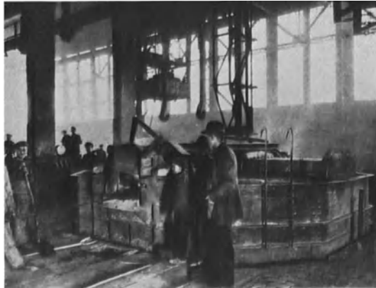
Abb. 62. 8 t-Induktionsofen, System Röchling-Rodenhauser und Siemens & Halske A.G.
