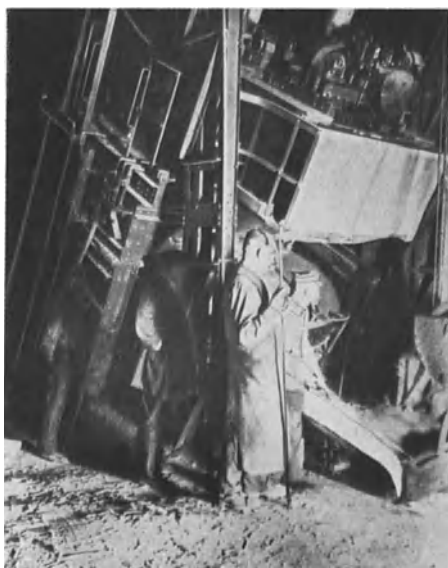
Abb. 61. 4 t-Drehstromlichtbogenofen in Kippstellung.
