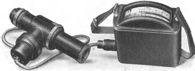
Abb. 62. Betriebsform des Siemens-Glühfadenpyrometers. Das Anzeigeeinstrument ist mit der Batterie zusammengebaut.
