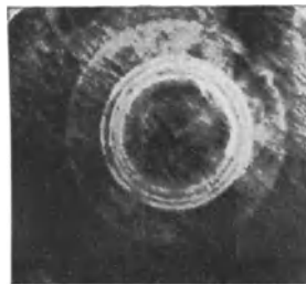
Abb. 443. Verfärbung von Flußpat durch die \alpha -Strahlen der Radiumfamilie. Aufnahme von B. GUDDEN.
