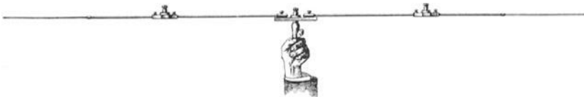
Abb. 462. Dipol mit drei Glühlampen zur Vorführung der Verteilung des Leitungsstromes in ihm.
