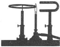
Abb. 222. Ein einseitig erhitztes Nickelrad rotiert im Felde eines Magneten. Bei 356 Zentigrad verliert Nickel seinen Ferromagnetismus, und dann zieht der Magnet ein kälteres, noch ferromagnetisches Stück des Rades heran. Die Mittelebene des Magneten geht durch die Radachse. Die Flamme wird je nach dem gewünschten Drehsinn etwas vor oder hinter diese Mittelebene gestellt.
