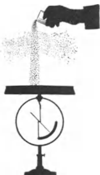
Abb. 423. Trennung von Elektrizitätsträgern durch verschiedene Fallgeschwindigkeit (feines Bleischrot und Schwefelpulver). Ein seitlicher oder aufwärts gerichteter Luftstrom verbessert die Trennung erheblich.
