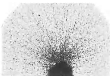
Abb. 434. Schußbahnen von \alpha -Strahlen in einer photographischen Platte. Vergrößerung etwa 500fach. Aufnahme von B. GUDDEN.
