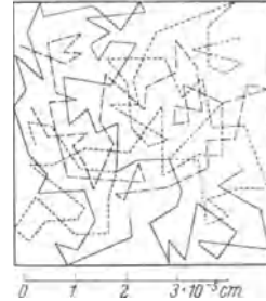
Abb. 56. Freie Weglänge von Gasmolekülen in Zimmerluft. Vergrößerung 6 \cdot 10^4 fach.
