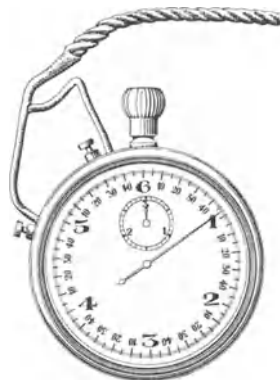
Abb. 39. Diese auf \frac{1}{10} Sekunde ablesbare Stoppuhr schließt einen Stromkreis während der Laufzeit ihres Zeigers. Sie ermöglicht die bequeme Herstellung bekannter Amperesekunden. Ein kaum weniger bequemer Zeitschalter kann leicht mittels eines Grammophonuhrwerkes improvisiert werden.
