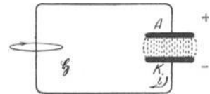
Abb. 159. Leitungsstrom beim Entladen eines Kondensators (vgl. Abb. 75). Als „Richtung“ des Leitungsstromes i bezeichnen wir stets die Wanderungsrichtung der negativen Elektrizitätsatome.
