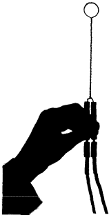
Abb. 183. Probespule zur Messung der Kraftflußdichte eines Elektromagneten. Eine Windung von 3 \text{ cm}^2 Fläche, also Windungsfläche nF = 3 \cdot 10^{-4} \text{ m}^2 .
