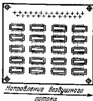
Рис. 8.11. Установка микросхем с учетом направления воздушного потока
