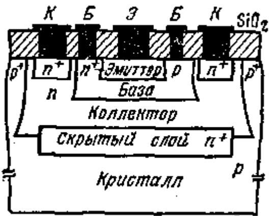
Рис. 1.4. Интегральный биполярный транзистор, изолированный электронно-дырочным переходом
