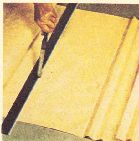
1. Разметка бумаги шпателем перед гофрировкой.
