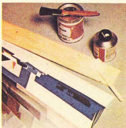
1. Нанесите клей на одну сторону деревянных планок и приклейте их к верхней и нижней краям шторы.
