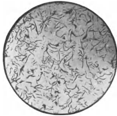
Fig. 35. Roheisen aus einem kleinen Hochofen.
