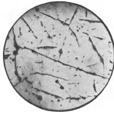
Fig. 37. Roheisen mit ausgeprägtem plattenförmigem Graphit.
