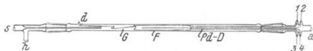
Abb 12. Pd-Folie und Einbau in das Versuchsgefäß (Maßstab 1 : 6). F Pd-Folie, Pd-D Pd-Zuleitungsdrähte, die in Glascapillaren eingeschmolzen sind, h Eintritt des Hauptstromes, s Eintritt des Seitenstromes, a Gasaustritt, 1, 2, 3 und 4 Öffnungen für die Zuleitungsdrähte der Pd-Folie, d Öffnung zur Durchführung eines Drahtes, der mittels eines Glashakens die Pd-Folie spannt, G Glashakchen.
