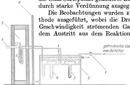
Abb. 19. Anordnung für katalytische Versuche im Umwandlungsgebiet ferromagnetischer Stoffe.
