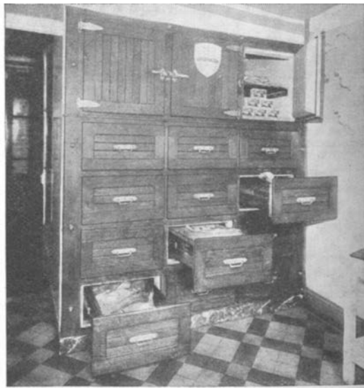
Armoire frigorifique pour grand établissement.
