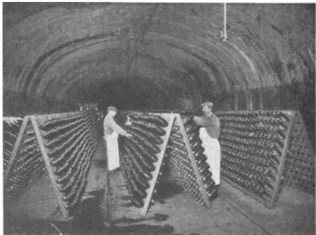
Cave de Champagne: aspect d'une galerie où les bouteilles sont mises sur pointe et où les ouvriers procèdent au remuage.
