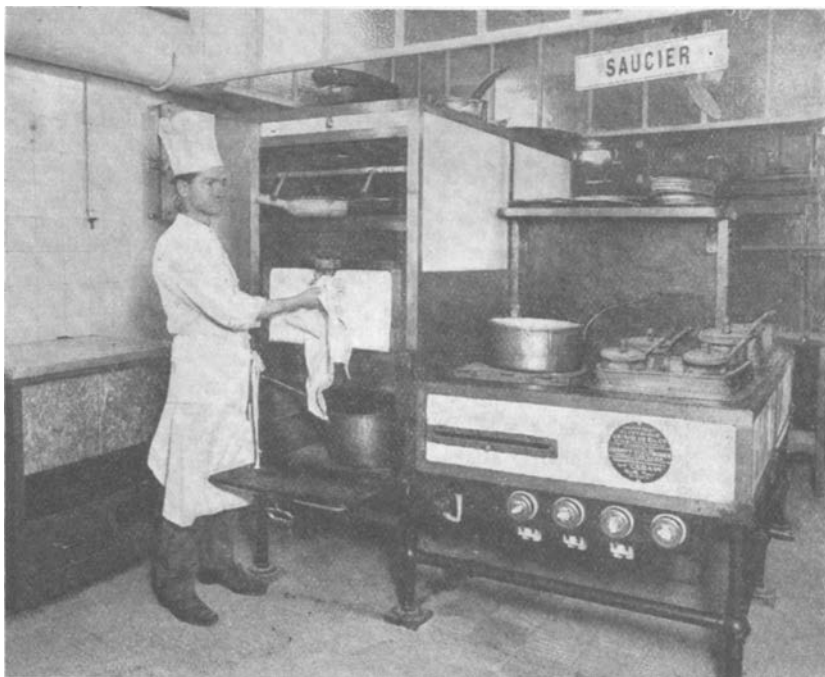
Le poste de travail du saucier dans un grand hôtel. L'équipement comprend deux fourneaux électriques et deux étages de fours surmontés d'une salamandre. [Phot. J. Boyer.]
