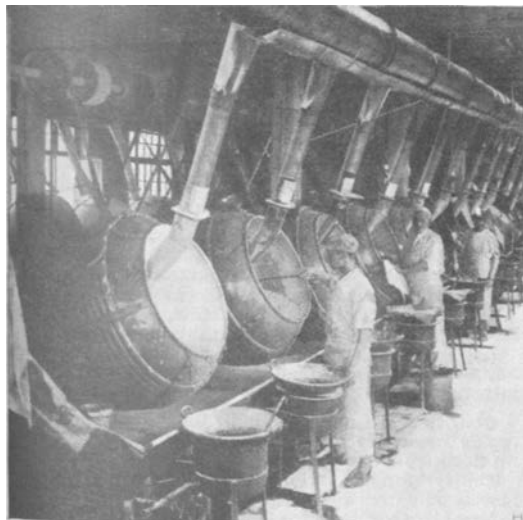
Turbines pour la fabrication des dragées. (P.Xat. H. Manuel.)
