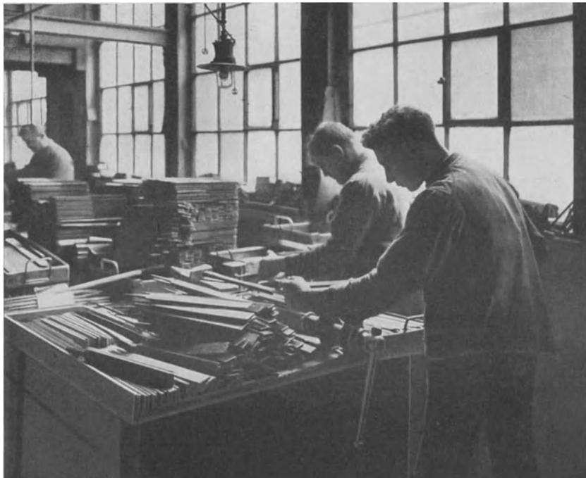
Abb. 273. Die Kontrolle der fertigen Feilen.
