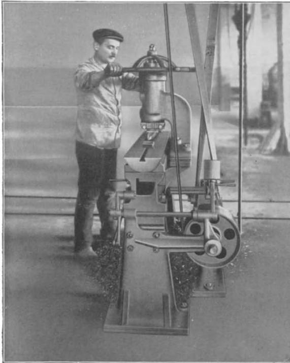
Abb. 238. Feilenhobelmaschine Béch , 1905.
