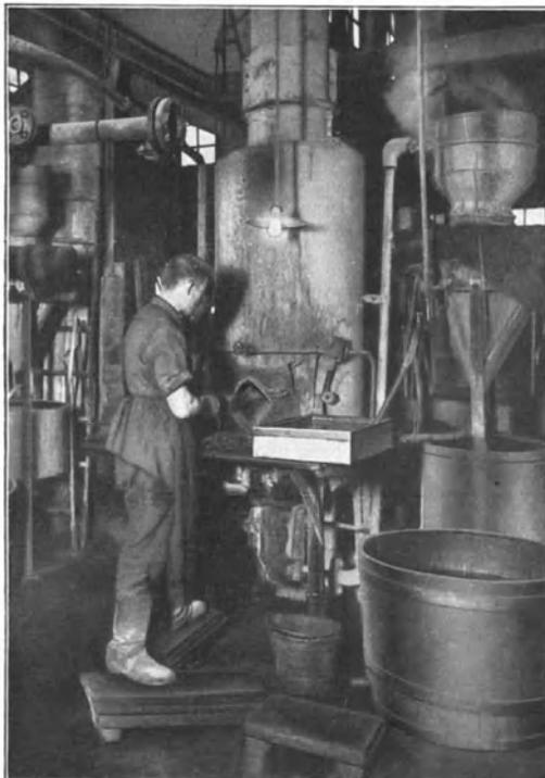
Abb. 267. Das Reinigen und Schärpen von Feilen mit Dampf-Sandstrahlgebläsen.
