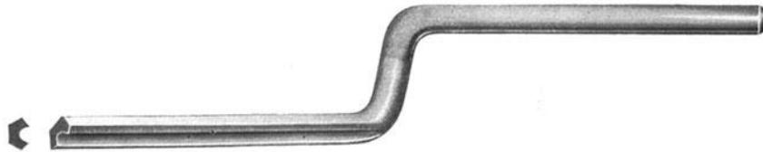
Abb. 42. „Feile an dem unteren Teile ausgegraben“, vom Verfasser nach der Beschreibung von Theophilus Presbyter ausgeführt und ausprobiert.
