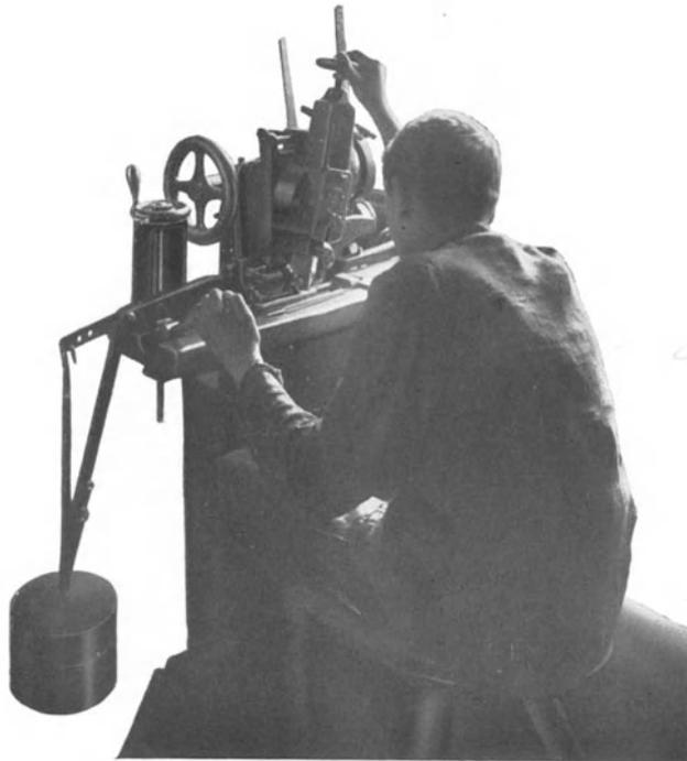
Abb. 256. Sägefeilenhauer an der Hess-Maschine.
