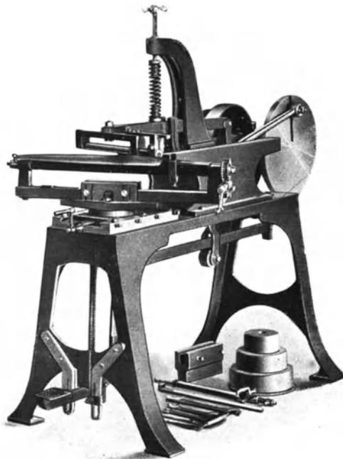
Abb. 261. Neuere Feilenschneidmaschine.
