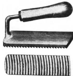
Abb. 74. Feile mit kreisbogenförmigen Zähnen aus dem Jahre 1774.
