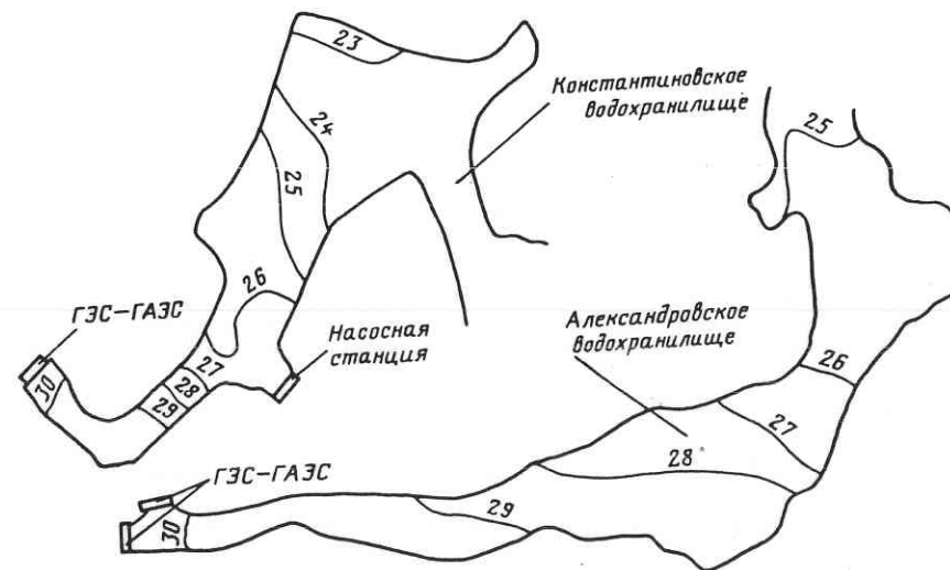
Рис. 6.2. Распределение среднесуточных температур в водоемах Южно-Украинского энергокомплекса, рассчитанное с использованием двумерной модели
