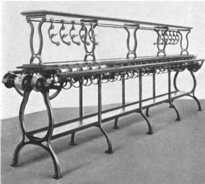
Abb. 102. Rückspulmaschine von G. Battaglia, Luino.
