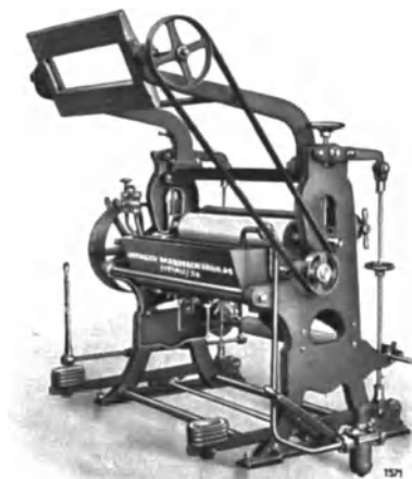
Abb. 289. Foulard von Zittauer Maschinenfabrik A.-G., Zittau.
