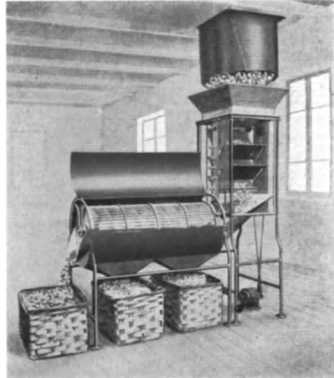
Abb. 42. Apparat zum Sortieren der Kokons nach Größe (cernitura) von Guiseppe Carini, Mailand.
