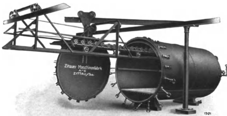
Abb. 278. Druckdämpfkessel von Zittauer Maschinenfabrik, Zittau.
