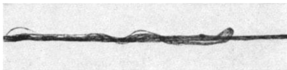
Abb. 84. Dicke und dünne Stellen in der Grège. Vergr. 1:25.
