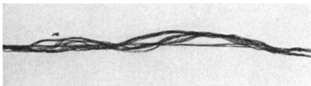
Abb. 91. Grègefehler „ungenügende Verklebung“. Vergr. 1:25.
