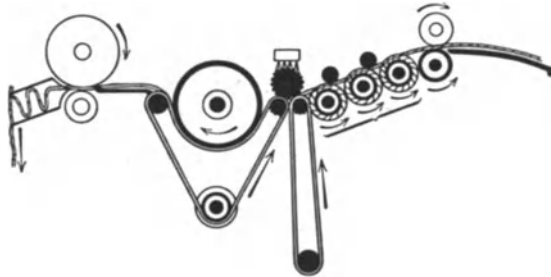
Abb. 154. Wattenmaschine nach Spennrath-Gürtler. Schematischer Riß.
