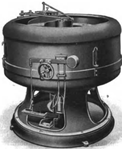
Abb. 169. Natronzentrifuge von Gebr. Heine, Viersen.
