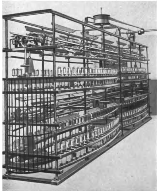
Abb. 106. Maschine zum Filieren auf Haspel nach G. Battaglia, Luino.
