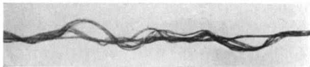
Abb. 123. Organzin fehlerhaft gezwirnt „Maltorto“. Vergr. 1:25.
