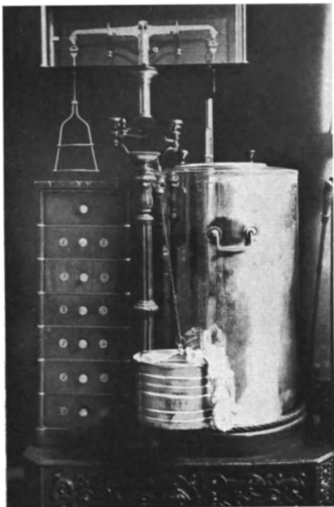
Abb. 126. Trocknungsapparat für Seide. Seidentrocknungs-A.-G. Elberfeld.
