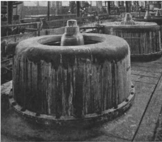
Abb.167. Natronzentrifuge von Clavel-Lindenmeyer, Basel.
