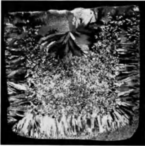
Abb. 201. Gußgefüge. Querschnitt durch Cu-Barren.
