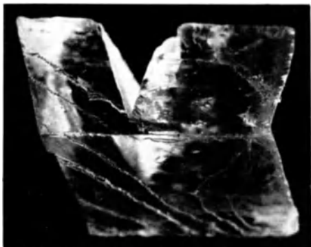
Abb. 47. Kalkspatzwilling, hergestellt durch Ein-drücken einer Messerschneide (nach BAUMHAUER).
