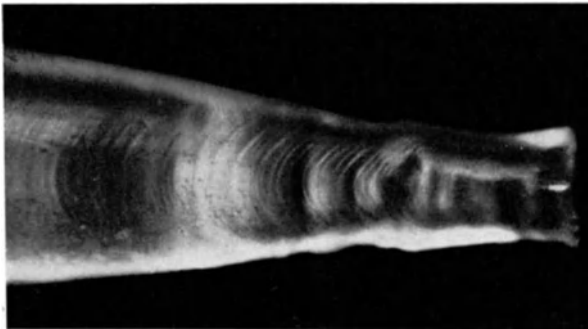
Abb. 195. Translationsstreifung auf unbelastet abgelöstem, nachher trocken zerrissenem NaCl-Kristall (551).
