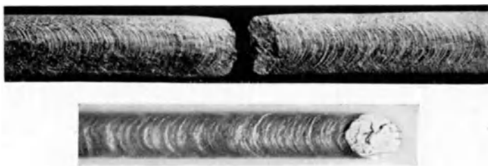
Abb. 94. Bruch von Mg-Kristallen (221, 210).
