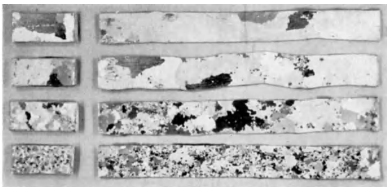
Abb. 172. Abhängigkeit der Korngröße nach Sammelkristallisation von Ausgangskorngröße. Al (416).
