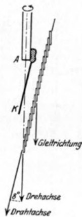
Abb. 55. Kristalljustierung zur Bestimmung der Trans- lationsrichtung aus Dreh- kristallaufnahmen (132).
