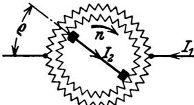
Abb. 417. Zweipoliges Schema eines Repulsionsmotors mit Bürstenverschiebung.
