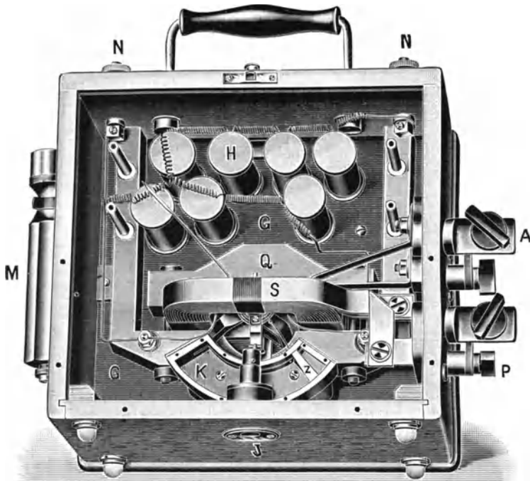
Abb. 492. Dynamometrisches Zeigerinstrument von Hartmann & Braun.
