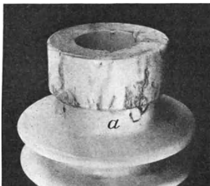
Abb. 454. Angriff (Ausbröckelung) des Porzellans durch gleitende Entladungen unter Öl.
