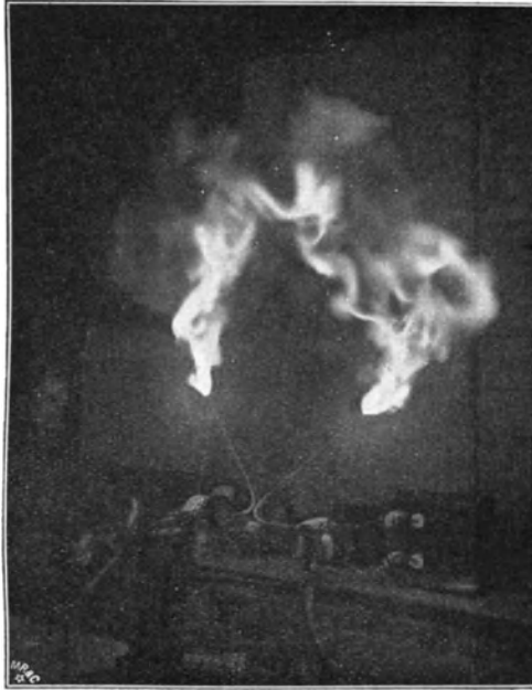
Abb. 92. Lichtbogen einer Hörnerblitzschutzvorrichtung kurz vor dem Verlöschen.
