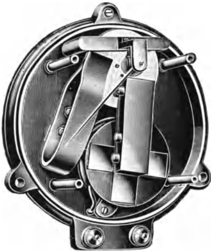
Abb. 501. Induktionsinstrument (Strom- oder Spannungsmesser) nach Benischke.
