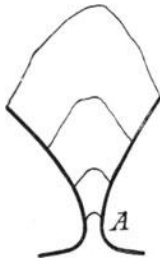
Abb. 91. Auftrieb eines Lichtbogens an Hörnern.
