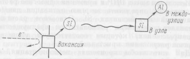
Рис. 18. Схема вытеснения примесного атома (Al) из узла кристаллической решетки атомом основного вещества (Si).
