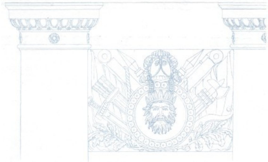
Рис. 45. Карандашный контур. В изображении архитектурных чертежей карандашный контур характеризуется точностью, тонкостью, минимумом линий и светлым тоном. Такой контур может быть нанесен твердым графитом по прочной бумаге. В глубоких тенях, где предполагается многократное нанесение красок, следует пользоваться более мягким графитом, чтобы контур оставался заметным до окончательной обработки деталей.
