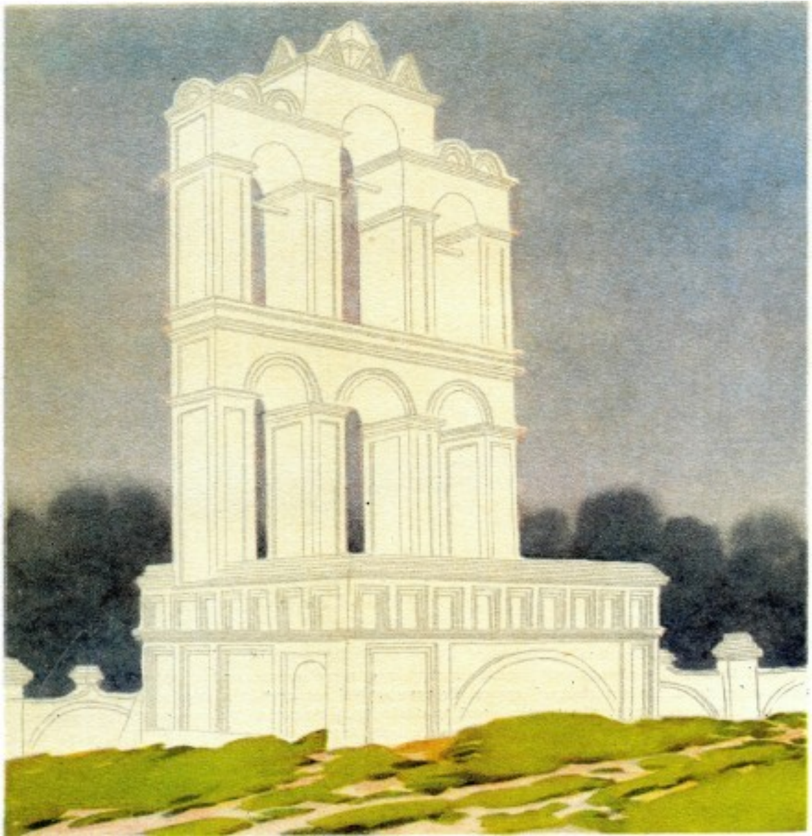
Рис. 57. Многоцветная моделировка в архитектурном чертеже. Начальная стадия передачи солнечного освещения на белом сооружении при безоблачном небе. Первый красочный слой характеризует прямой свет солнца — главного источника света. Второй слой характеризует полутона, освещенные вторым по силе источником света — голубым небом.
