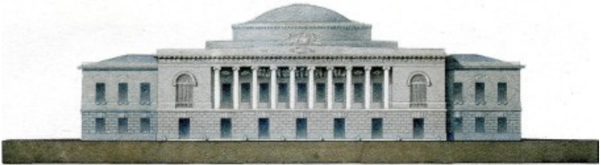
Рис. 85. Архитектурная графика мастеров начала XIX века. Фасад дворца. Проект архитектора А. Г. Григорьева. Чертеж показывает приемы акварельной техники, которые характеризуются простотой и лаконизмом исполнения, законченностью деталей, сдержанностью окраски и правдивым для архитектуры севера серебристым колоритом.
