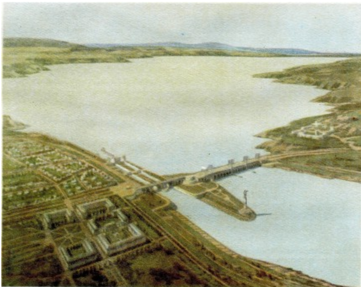
Рис. 124. Приемы изображения панорамы гидроузла. При высоком горизонте перспективные планы создаются при помощи линейной и воздушной перспектив с равномерным освещением всего пространства.
