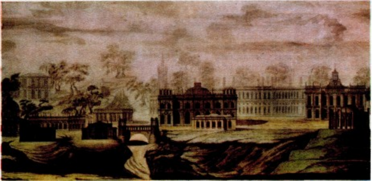
Рис. 114. Приемы мастеров XVIII века в отмывке чертежей тушью. Фрагмент панорамы усадьбы Царицыно В. И. Баженова. Перспективные планы панорамы создаются в результате применения контрастных светотеневых отношений на переднем плане и нюансных—на дальнем.
