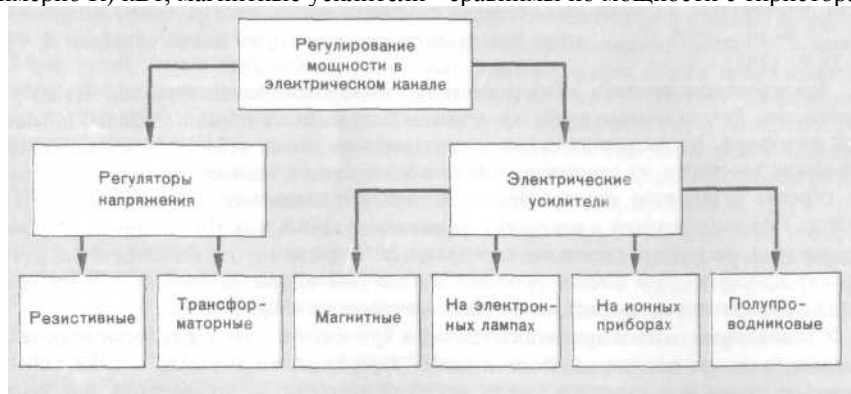
Рис. 20. Способы регулирования мощности в электрическом канале
