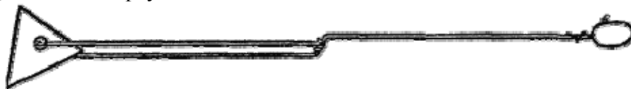
Рис. 17. «Тренировочная вилка» для опытов с рыбами. Ее укрепляют на краю аквариума так, что «опознавательный знак» остается снаружи, а кусочек пищи — в воде
