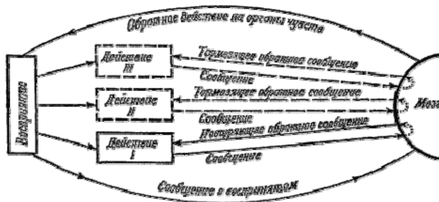
Рис. 31. Кибернетическая блок-схема для пояснения сообщения и обратного сообщения. (Мозг получает сообщение об «успехе» только при действии I)
