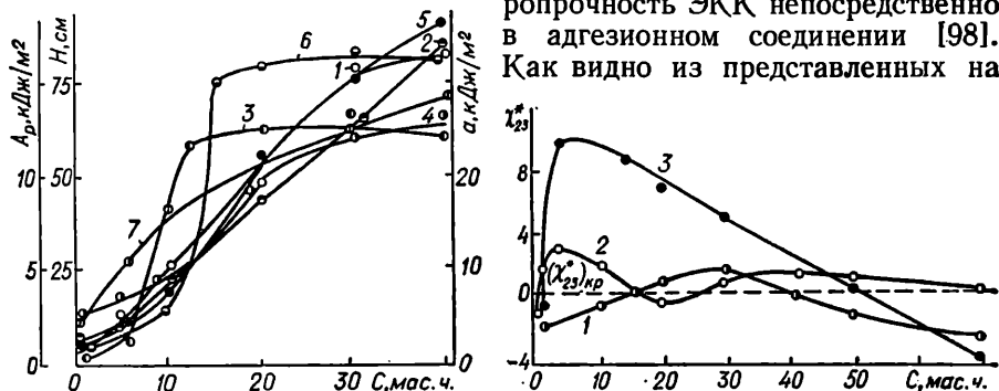
Рис. 5.20. Зависимость показателей ударного сдвига H (1—4), работы разрушения A_p (5, 6) и удельной ударной вязкости a (7) от содержания каучука C для композиций на основе ЭО ЭД-20 (1—3, 5—7) и УП-637 (4), отвержденных УП-0639 (1, 4, 5, 7), ПО-300 (2) и ПЭПА (3, 6)
