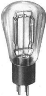
Abb. 75. Doppelanodenröhre (Siemens-Reiniger-Werke).
