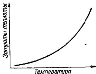
Рис. 9. Зависимость затрат теплоты на нагрев реагирующих масс от температуры реакционного объема.
