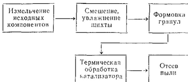
Измельчение исходных материалов в значительной степени определяет однородность контактной массы. Процессы измельчения условно подразделяют на дробление (крупное, среднее и мелкое) и измельчение (тонкое и сверхтонкое). Однородность катализатора возрастает со степенью измельчения  $n$  исходных материалов
