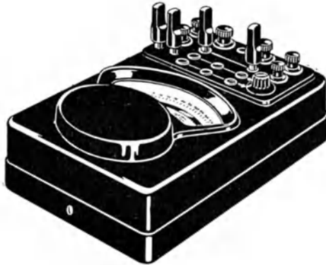
Bild 3. Neuer Präzisions-Leistungsmesser in Preßstoffgehäuse; Laboratoriumstyp (S. & H.).
