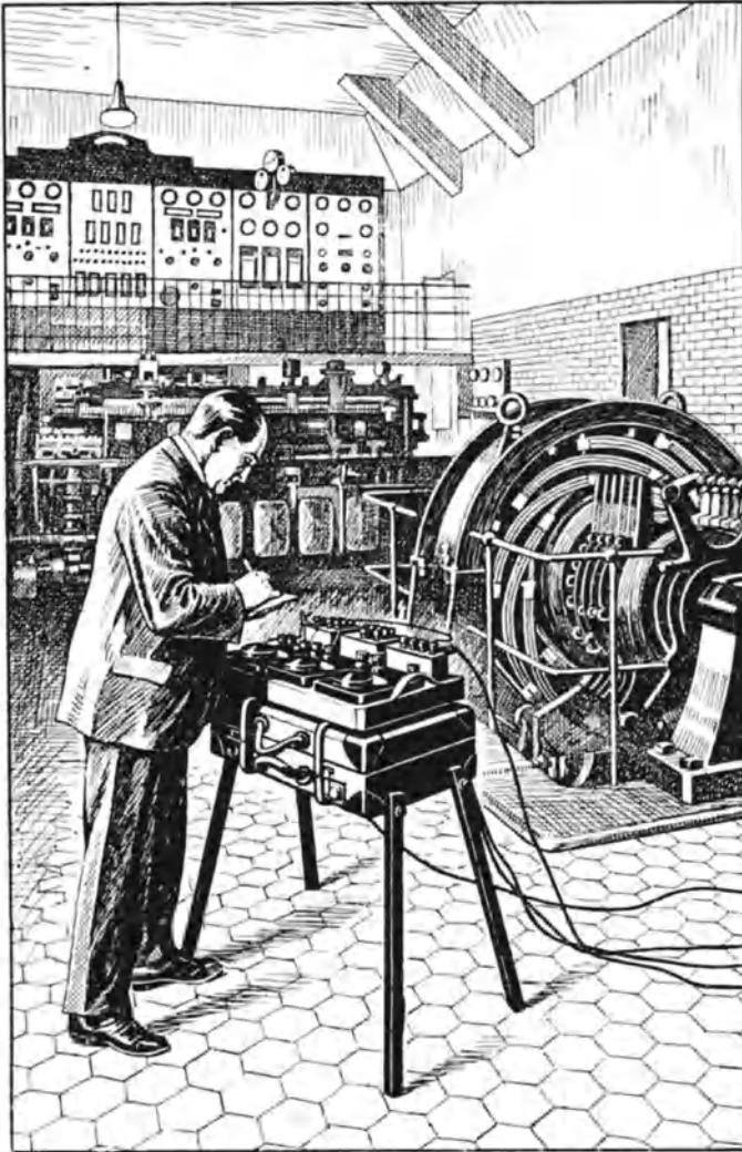
Bild 141. Meßkoffer mit Prüffeld-Instrumenten für halbindirekte und indirekte Messungen, betriebsfertig aufgestellt.
