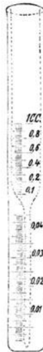
Abb. 10 a. Graduiertes Röhrchen für Globulinnieder- schläge mit festem Boden nach Kafka. ( \frac{1}{2} natürlicher Größe.)
