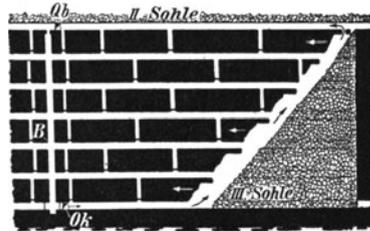
Abb. 113. Pfeilerbau mit geschlossenem Versatz.
