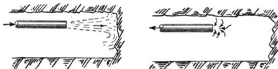
Abb. 157. Wirkung der blasenden und der saugenden Luttenbewetterung.
