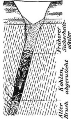
Abb. 123. Tagebruch bei steiler Lagerung.
