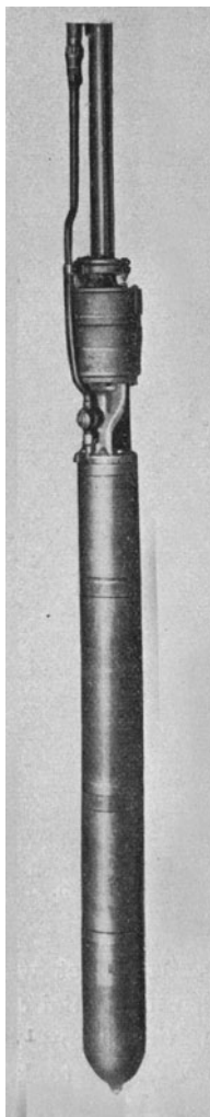
Abb. 6. Motorsenkpumpe für Tiefbrunnen. Die bei der Grundwasserabsenkung für den Umbau und die Erweiterung der Staatsoper Unter den Linden in Berlin zur Verwendung gekommene Tauchmotorpumpe der Siemens-Schuckertwerke.
