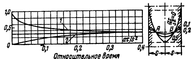
Рис. 3-2. График выравнивания температур в плоской стенке при условии, что тепловой поток через поверхность равен нулю. 1 — температура наружной поверхности; 2 — температура средней поверхности.
