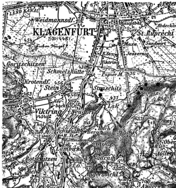
Abb. 107. Die Quellen bei Straschitz gehören zu den Wallern und speisen die Ergänzungswasserleitung von Klagenfurt. Die Quellen östlich von Lak sind Grenschlauchquellen und liefern das Wasser für das alte Wasserwerk der Stadt (die östlichste Quelle ist noch ungefaßt).
