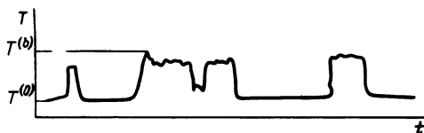
Рис. 1.19. Осциллограмма пульсаций температуры при горении однородной смеси по данным Кокушкина [1960]. Опыты проведены с бензино-воздушной смесью; коэффициент избытка воздуха \alpha = 1,6 - 1,8 ; начальная температура 573 К; давление нормальное. Смесь горела за коническим стабилизатором диаметром 6 см, расположенным на срезе трубы диаметром 40 см. Скорость истечения составляла 90–110 м/с. Измерения проводились на расстоянии 40 см от среза трубы. Единицы измерения по осям координат произвольны
