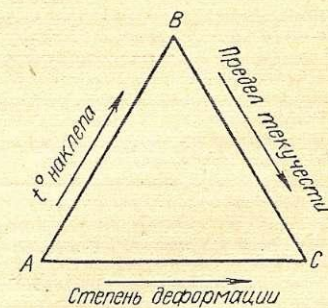
Рис. 4. Зависимость предела текучести от степени и температуры деформации для стали ČSN17455.
