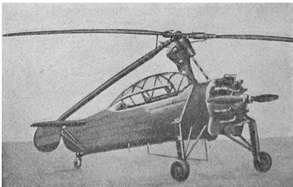
Фиг. 72. Автожир Келлет YO-60 (США. 1944), взлетающий без разбега и садящийся без пробега.
