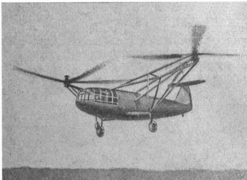
Фиг. 129. Германский вертолет Фокке-Ахгелис Fa-223 с мотором 1000 л. с.
