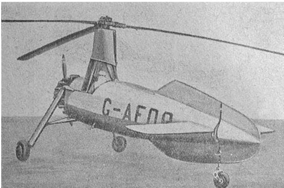
Фиг. 58. Серийный двухместный автожир Сиерва С-40 с автодинамической втулкой, взлетающий без разбега, с непосредственным управлением и трехлопастным ротором.
