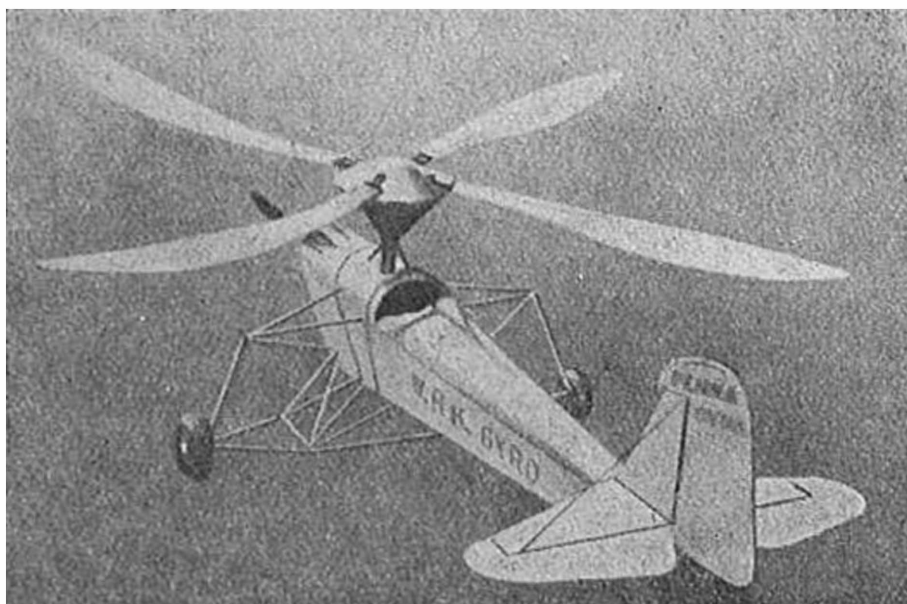
Фиг. 43. „Жироплан“ Вильфорда—автожир с самолетными органами управления, имеющий четырехлопастный „жесткий“ ротор с оригинальной колебательной системой стабилизации винта.
