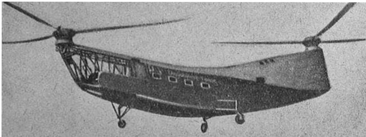
Фиг. 131. Транспортный вертолет Пясецкого PV-3 с мотором Континенталь-Райт мощностью 600 л. с. Два трехлопастных винта, расположенные в носовой и хвостовой частях фюзеляжа, вращаются в противоположных направлениях.
