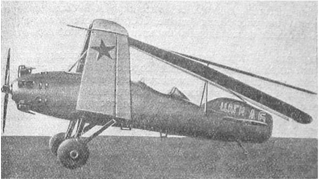
Фиг. 36. Крылатый автожир ЦАГИ А-6 конструкции В. А. Кузнецова с мотором М-11 и трехлопастным свобод- нонесущим ротором со складывающимися лопастями, име- ющим механический запуск, и консолями крыльев.
