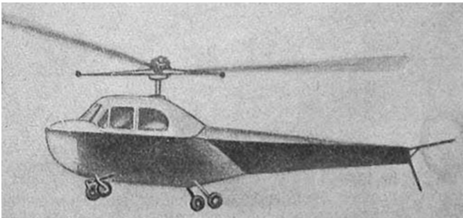
Фиг. 96. Двухместный геликоптер фирмы Белл Mod-47 с мотором Франклин 178 л. с.
