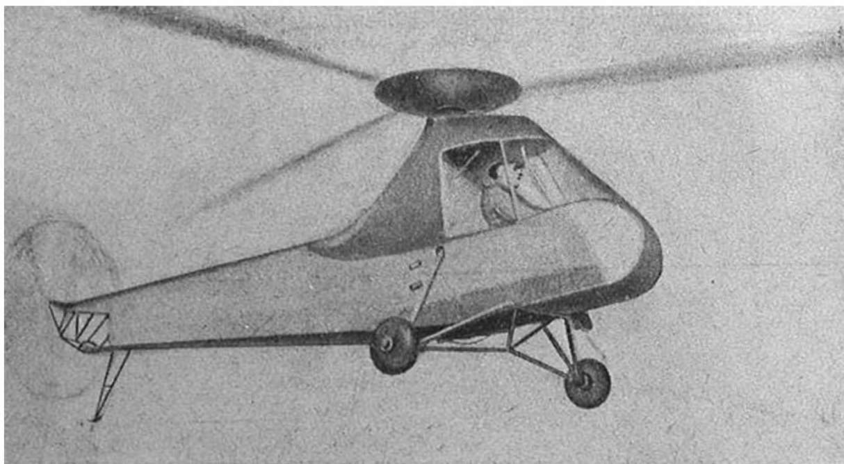
Фиг. 91. Геликоптер Ф. Пясецкого PV-2 с мотором Франклин 90 л. с., полетный вес 450 кг.
