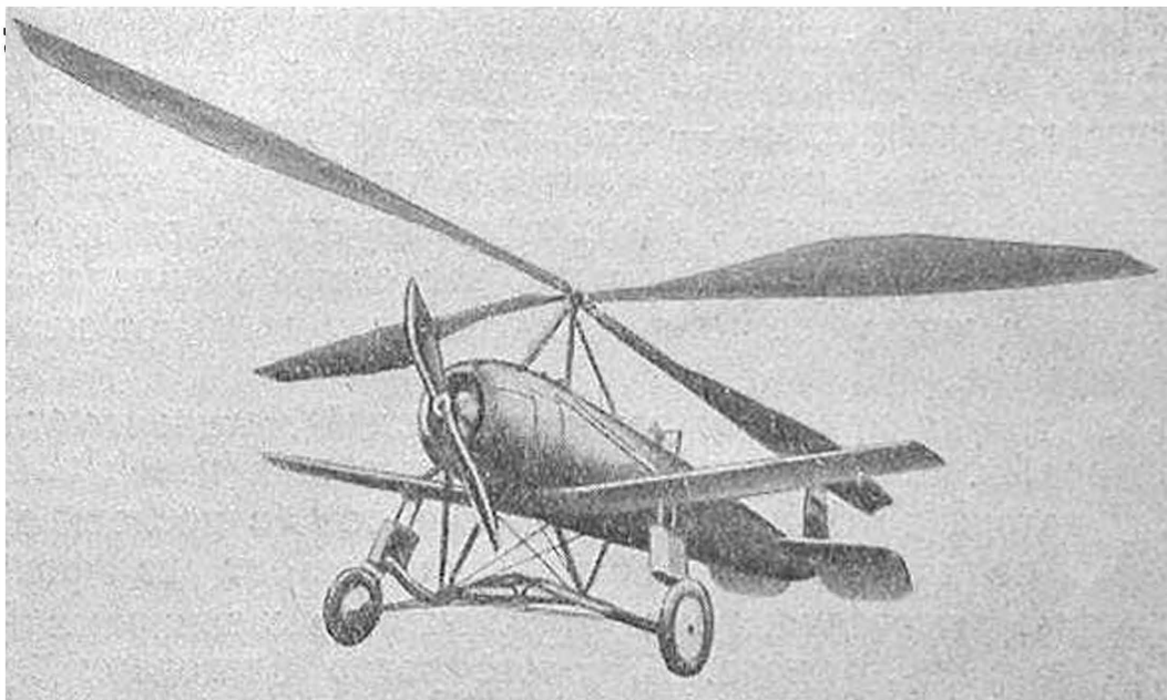
Фиг. 35. Первый советский „вертолет“ (автожир) КАСКР-1 „Красный инженер“ с мотором М1—110 л. с. и четырехлопастным ротором расчалочного типа, конструкции Н. И. Камова и Н. К. Скржинского, спроектированный в 1928 г.
