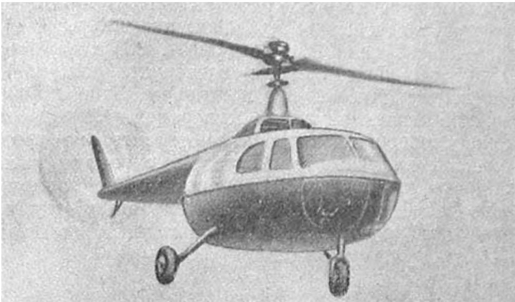
Фиг. 95. Пятиместный пассажирский геликоптер фирмы Белл Mod-42 с мотором Прайт-Уитни мощностью 450 л. с.
