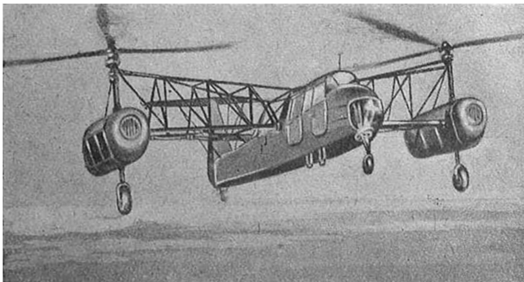
Фиг. 127. Двухвинтовой двухмоторный геликоптер „Омега“ конструкции И. П. Братухина с шарнирной поводковой подвеской лопастей, управлением автоматами-перекосами в продольном направлении и механизмами изменения общего шага. Винты синхронизированы поперечной трансмиссией.
