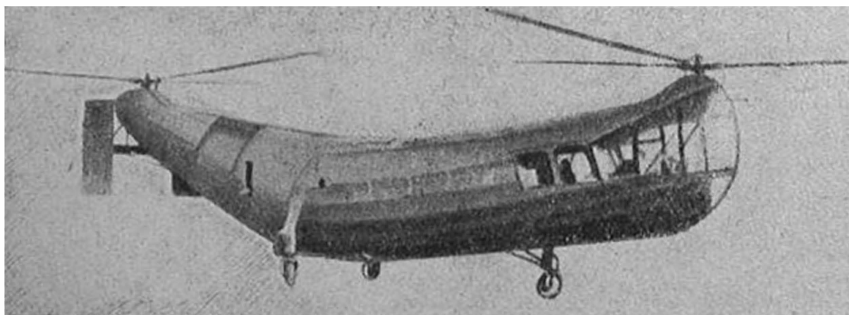
Фиг. 134. Восьмиместный вертолет Пясецкого HXRP-1 с мотором мощностью 600 л. с.
