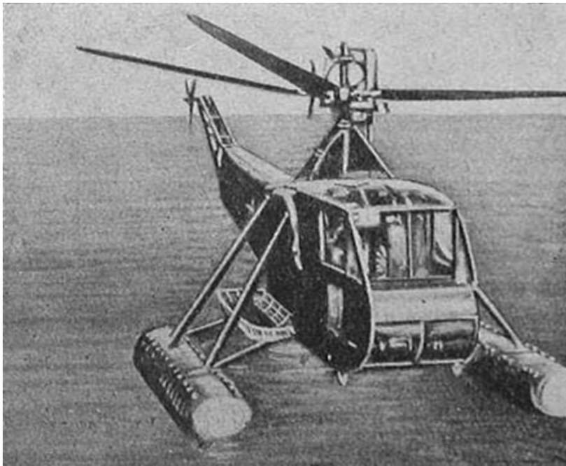
Фиг. 83. Двухместный вертолет Сикорского HNS-1 с мотором Уорнер „Супер Скерб“ 175 л. с., строящийся серийно для армии и флота США.
