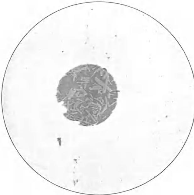
Abb. 8. Schlackeneinschluß in Flußeisen (ungeätzt). 500:1.
