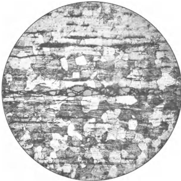
Abb. 4. Perlit + Ferrit + Schlacke. 200:1.
