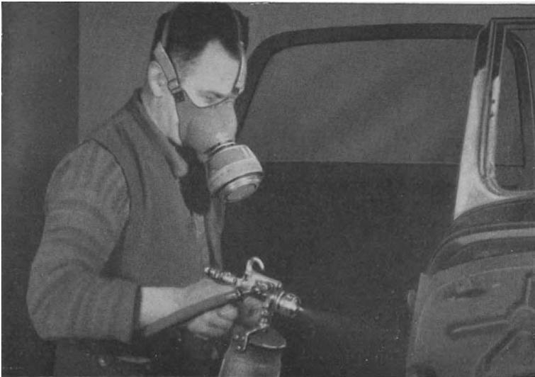
Abb. 11. Schutzmaske mit Industrieinsatzfilter beim Spritzen sperriger Stücke.
