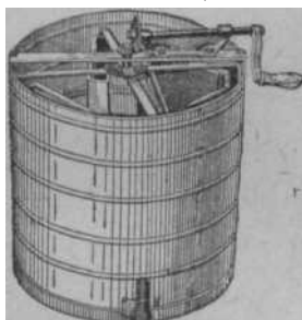
Рис. 2. Четырехрамочная медогонка с оборачивающимися от руки кассетами.
