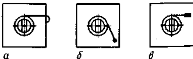
Рис. 6.4. Варианты закрепления пружины якоря электромагнита: а — зацепление за корпус электромагнита; б — введение конца пружины в отверстие; в — припаивание
