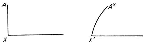
Fig. 3. Bildfeldwölbung. Eine achsensenkrechte Ebene, deren Durchschnitt  $XA$  ist, wird in einer krummen Fläche mit dem Durchschnitt  $X'A^x$  abgebildet.
