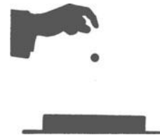
Abb. 94. Zum Energiesatz. Eine Stahlkugel tanzt über einer Stahlplatte. Man kann die Stahlplatte durch eine beruhte Glasplatte ersetzen. Dann läßt sich die Abplattung der Kugel beim Aufprall gut erkennen.
