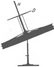
Abb. 143. Kräftefreier Kreisel mit raumfester Figurenachse.
