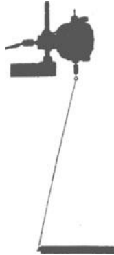
Abb. 134. Ein Stab umkreist die Achse seines größten Trägheitsmomentes als freie Achse.
