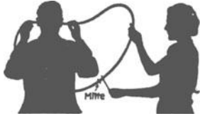
Abb. 439a. Zum Richtungshören: Man hält sich die beiden Enden eines etwa 2 m langen Gas Schlauches in die Ohren und läßt einen Helfer auf den Schlauch klopfen. Die Schallrichtung weicht von der Medianebene des Kopfes ab, wenn die Klopfstelle um mehr als 0,5 cm von der Schlauchmitte entfernt liegt. Der Hörsinn reagiert also schon auf Laufzeitdifferenzen \Delta t = 3 \cdot 10^{-8} \text{ sec} . Bei \Delta t = 60 \cdot 10^{-8} \text{ sec} (entsprechend 20 cm Wegdifferenz, Kopfdurchmesser!) lokalisiert man die Schallquelle quer zur Medianebene.
