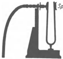
Abb. 297. Hydrodynamische Selbststeuerung einer Stimmgabel.
