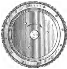
Abb. 52. Kette auf Schwungrad. Zur Vorführung einer dynamischen Stabilität.
