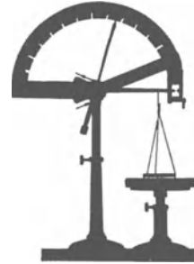
Abb. 224. Zur Messung der spezifischen Oberflächenarbeit mit Hilfe einer Schneckenfederwaage. Zahlenbeispiel für Wasser. Ringdurchmesser 5 cm; Umfang 2l = 0,31 m; \mathfrak{R} = 2,3 Pond = 2,24 \cdot 10^{-2} Groödyn; \zeta = 0,072 Wattsec/m 2 .
