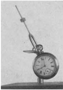
Abb. 356. Resonanz zwischen Uhrgehäuse und Unruhe.
