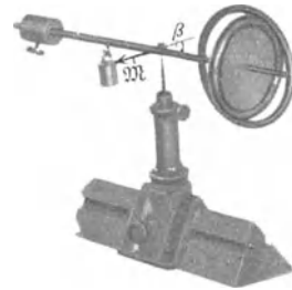
Abb. 146. Kippung eines ruhenden Kreisels unter der Einwirkung eines Drehmomentes. Der Kippwinkel \beta liegt in der vertikalen, die Kreiselachse enthaltenden Ebene.
