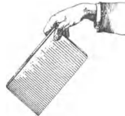
Abb. 137. Abschleudern einer Kiste zur Drehung um ihre freie Achse A mit größtem Trägheitsmoment.
