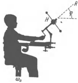
Abb. 181 b. Modellversuch zum Nachweis der Erddrehung durch Baron v. Eötvös.
