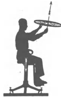
Abb. 128. Zur Erhaltung des Drehimpulses. (Bei kleinen Beschleunigungen wird man durch Reibung gestört.)
