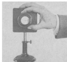
Abb. 428. Ein feines Glashaar als Bewegungsempfänger. In Wirklichkeit nur 0,023 mm dick.
