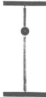
Abb. 78. Herstellung von Lissajous-Bahnen mit Hilfe elastischer Kräfte.
