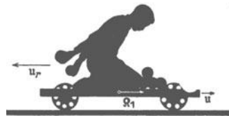
Abb. 111. Zur Erzeugung der Antriebskraft \mathfrak{R}_1 für Wasser- und Luftfahrzeuge.
