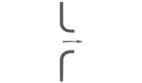
Abb. 518. Beispiel einer einfachen, für die Herstellung von Überschallgeschwindigkeit unbrauchbaren Düse.
