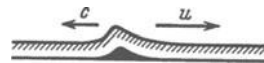
Abb. 520. Hydraulischer Wassersprung. Zur Veranschaulichung eines Verdichtungsstoßes in einem mit Überschallgeschwindigkeit strömenden Gase. Die Strömungsgeschwindigkeit u ist größer als die Geschwindigkeit c der Oberflächenwellen [Gleichung (198) v. S. 162]. Infolgedessen kann sich die bei dem Hindernis ausbildende Störung nicht stromaufwärts bemerkbar machen.
