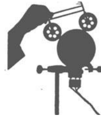
Abb. 149. Ein Fahrradmodell wird durch Anpressen an eine Scheibe auf der Achse eines Elektromotors in Gang gesetzt.
