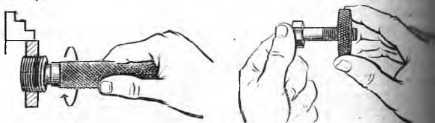
Рис. 65. Контроль резьб резьбовым калибром
