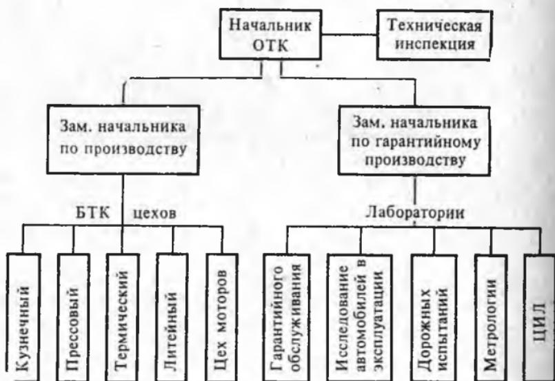
Рис. 106. Типовая схема организации ОТК
