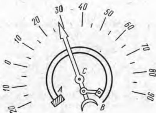
Рис. 31. Биметаллический термометр
