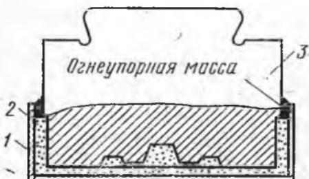
Рис. 46. Защита ковочных молотовых штампов от окисления и обезуглероживания
