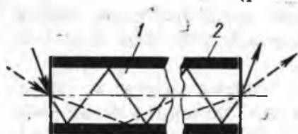
Рис. 55. Схема хода луча в световоде:
