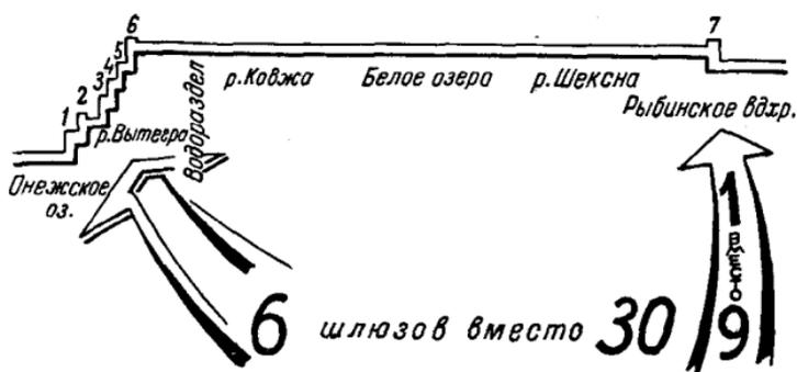
Рис. 9. Профиль Волго-Балтийского водного пути («Волго-Балт», 1947).
