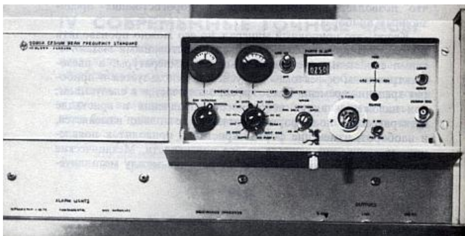
78. Цезиевый лучевой эталон частоты в Хёрстмонсо, 1974 г. Изготовлен фирмой 'Хьюлетт-Паккард', тип 5060 А. (Гринвичская обсерватория.)
