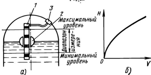
Рис. 1.34. Расположение преобразователей в баке системы контроля уровня топлива (а) и график изменения объема верхней части бака по его высоте  $H$  (б):
