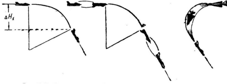
Рис. 7.63: Основные способы ввода самолета в пикирование
