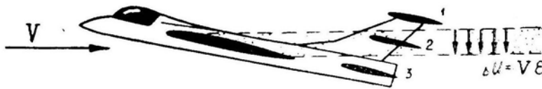
Рис. 2.71: Правильное (1 и 3) и неправильное (2) расположение горизонтального оперения
