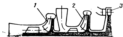
Рис. 3.105. Схема турбонасосного агрегата с консольным расположением насоса окислителя:
