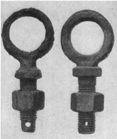
Abb. 308. Angriff von Grundwasser auf die schmiedeeiserne Öse eines Rohrbrunnens aus Gußeisen.
