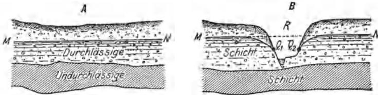
Abb. 6. Schematische Darstellung der Entstehung einer durch Grundwasser gespeisten Quelle.
