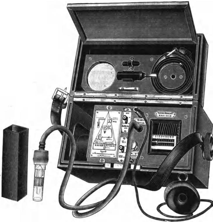
Abb. 175. Tragbarer Apparat zur Messung des Leitvermögens von Wässern. (Nach Pleißner.)
