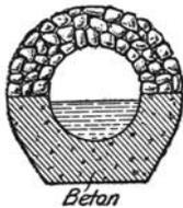
Abb. 257. Sickerstrang aus Beton und Trockenmauerwerk.
