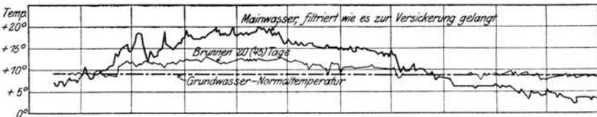
Abb. 326. Schaulinien der Temperatur, beobachtet in der Grundwassererzeugungsanlage der Stadt Frankfurt a. M. (Nach Scheelhaase.)
