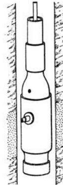
Abb. 252. Anbohrvorrichtung zum Erschließen tiefer Wasseradern. (Nach Herzog.)
