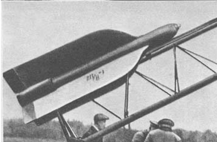
Ракета 217 с системой наведения по лучу прожектора.
