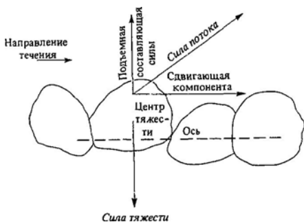
Рис. 6.2. Схема сил, действующих на зерно, лежащее на дне, которое сложено такими же зернами и подвергается действию потока жидкости, проходящего над ним
