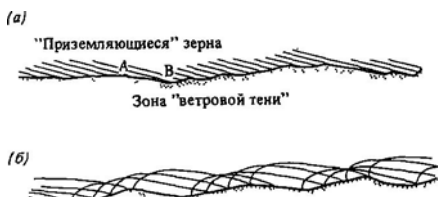
Рис. 8.23. а — первоначальные неровности обрисовывают зоны «ветровой тени», защищенные от ударов зерен, приземляющихся после сальтации почти под постоянными углами траектории. Углубление понижений, образующихся у подножия теневых зон, приводит к образованию баллистической ряби, б — длина волны баллистической ряби совпадает со средней длиной прыжка сальтации [41]
