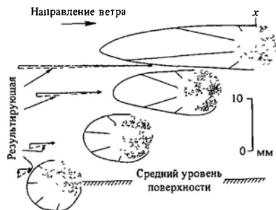
Рис. 6.3. Схема примерной разницы давления на точке x на макушке шара (7,5 мм) и на других точках на поверхности сферы в потоке воздуха. На шар действуют и подъемная сила, и сила волочения. Подъемная сила резко снижается высотой, а волочение растет из-за прямого давления ветра. Скорость ветра на высоте 20 м над поверхностью равна 7,7 \text{ м} \cdot \text{с}^{-1} , срывающая скорость составляет 0,98 \text{ м} \cdot \text{с}^{-1} . Длина линий в контурах вокруг зерен показывает относительные различия в давлении воздуха [151]
