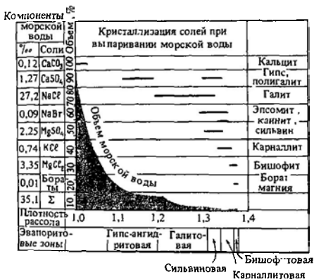
Рис. 3.1. Изменение объема образующегося рассола, его плотности и типа осаждающихся солей при выпаривании морской воды (по Валашко [836])
