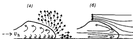
Рис. 7.7. Характер движения внутри и вокруг головной части мутьевого потока a — движение относительно ложа, б — наблюдатель неподвижен, в — движение относительно перемещающейся головной части, г — наблюдатель движется с той же скоростью, что и голова потока [570, 16]
