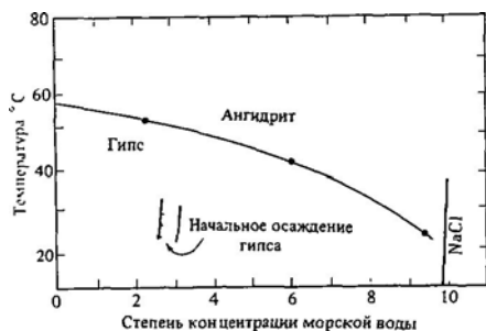
Рис. 3.3. Фазовая диаграмма, показывающая поля устойчивости гипса и ангидрита при различных температурах рассола и степени концентрации морской воды (по данным Харди [338], пересчитанным в единицы концентрации (исходя из \text{H}_2\text{O} ) Блэттом и др [85])
