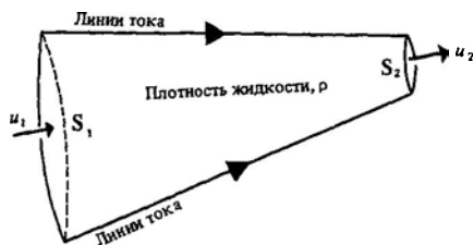
Рис. 5.2. Конический трубопровод, иллюстрирующий неразрывность потока между двумя сходящимися линиями тока. В постоянном потоке масса жидкости, проходящая через любое сечение, одинакова, т. е. \rho u_1 S_1 = \rho u_2 S_2 . Следовательно, если S_1 > S_2 , то u_2 > u_1 , \rho — плотность жидкости, S — площадь поперечного сечения, u — скорость
