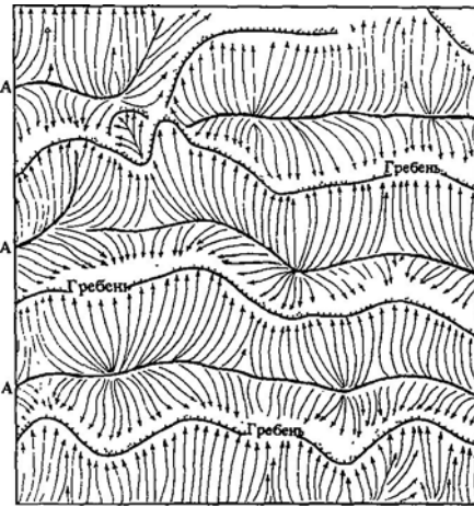
Рис. 8.5. Распределение линий тока в основании потока (средняя скорость 0,22 \text{ м} \cdot \text{с}^{-1} , глубина 0,095 \text{ м} ) над дном с рябью течения. Течение направлено снизу вверх. Гребни ряби являются линиями отрыва потока. Крутые участки обрушения обозначены крапом [15].
