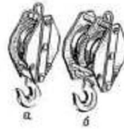
Рис. 39. Полиспастные блоки: a - однорольный грузоподъемностью 5 т; б - двухрольный грузоподъемностью 10 т
