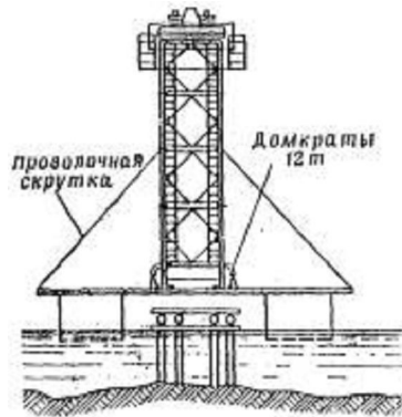
Рис. 60. Монтаж опоры с помощью парома
