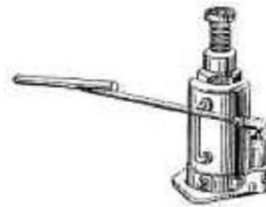
Рис. 41. Гидравлический домкрат грузоподъемностью 30 т
