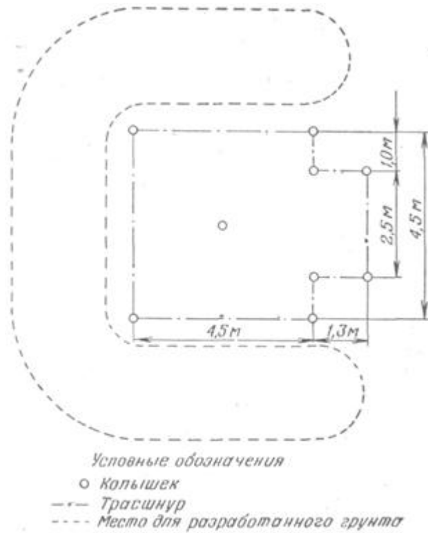
Рис. 153. Трассировка котлована с наклонными стенками
