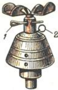
Рис. 66. Закрепление ветрянки и ударника взрывателя: 1 — вилчатая чека; 2 — предохранительная чека ударника
