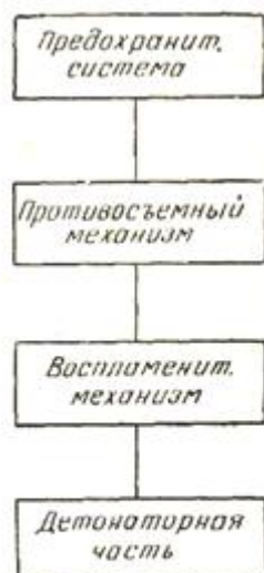
Рис. 59. Схема комплектования взрывателей-ловушек
