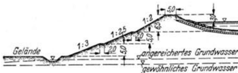
Abb. 8. Kanal im Auftrag.
