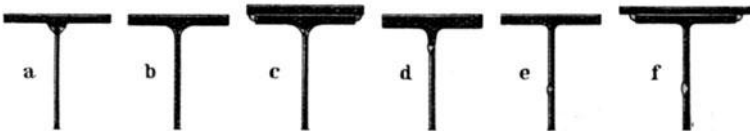
Abb. 140. Trägerquerschnitte mit Sonderprofilen.
