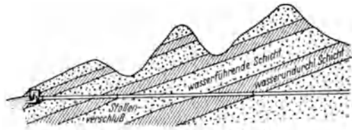
Abb. 13. Stauvorrichtung in Stollenfassung.
