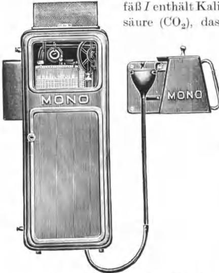
Abb. 18. Selbstregistrierender Gichtgasprüfer „Duplex-Mono K“.
