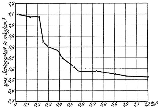
Abb. 29. Beziehung zwischen Schlagarbeit und Phosphorgehalt (Wüst und Scholz).
