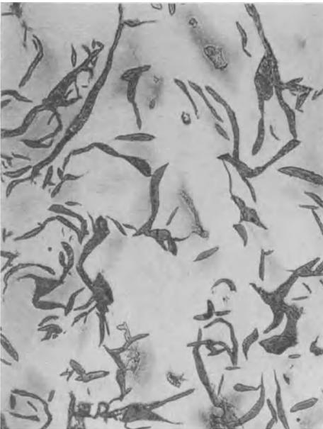
Abb. 49. Grauguß mit austenitischer Grundmasse (unmagnetischer Guß).
