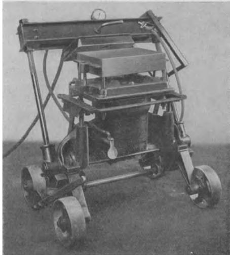
Abb. 30. Fahrbare Druckluft-Formpresse (Bauart Hainholz).
