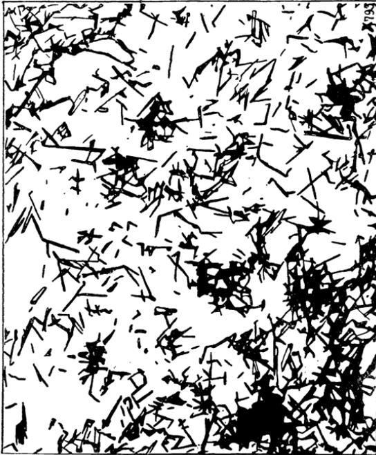
Abb. 2. Silimanit aus hochgebranntem (Segeberkegel 15, 1430°) Wildsteiner Ton, durch Flußsäure isoliert.
