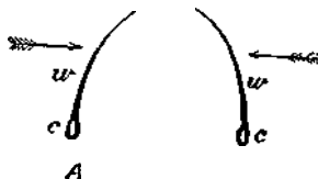
Фиг. 19. Згибаніе крыльевъ подѣ вліяніемъ давленія воздуха.
